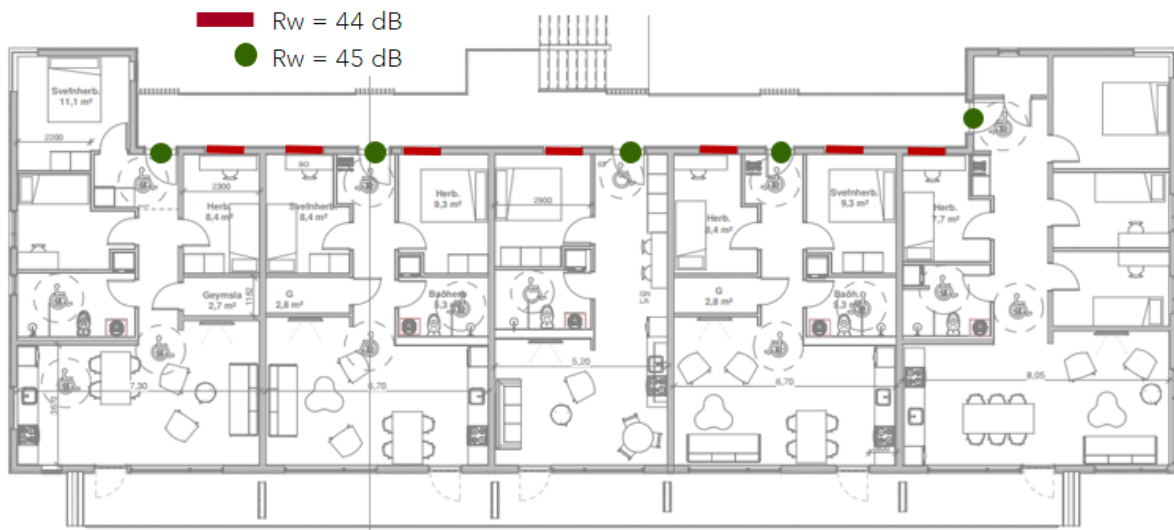
MYND 3 Kröfur til lofthljóðeinangrunar glugga sem að snúa að svalagangi og hurða á efri hæð Víkurbó 57.
